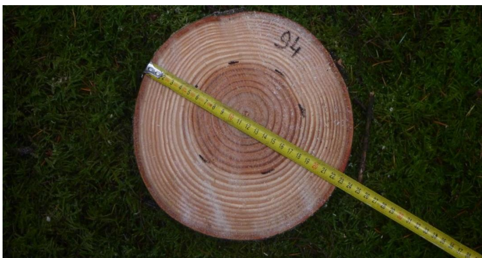
Figure 6 Exemple de photo de rondelles réalisées permettant la mesure de la quantité de duramen
