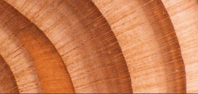
Puis des prélèvements micrométriques suivant les trois plans du bois (transversal, tangentiel et radial) vont permettre de mettre en évidence la structure cellulaire des bois propre à chaque essence de bois.
