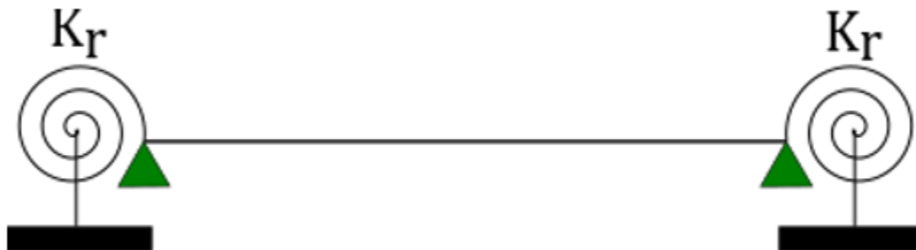
Figure 103 - Analyse du plancher sous l'effet d'un serrage avec des ressorts en rotation
