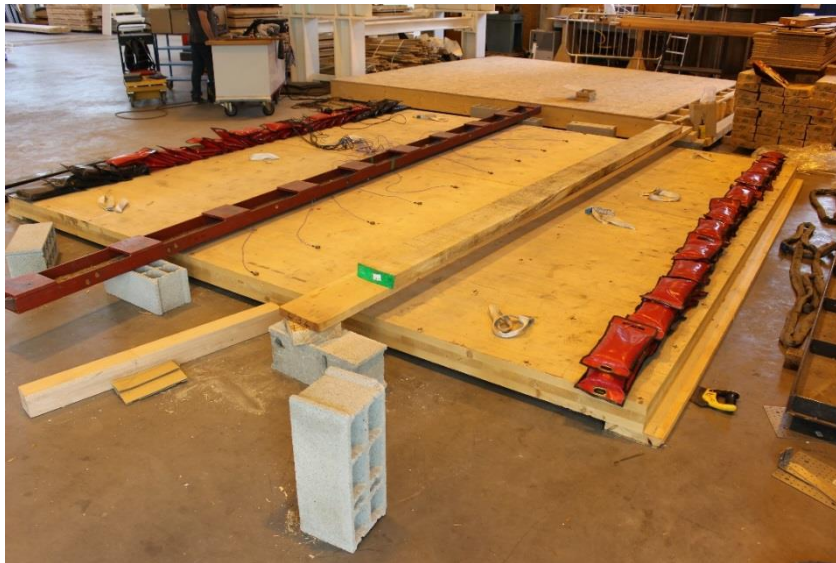
Figure 10 - Configuration d'essai pour le plancher CLT
