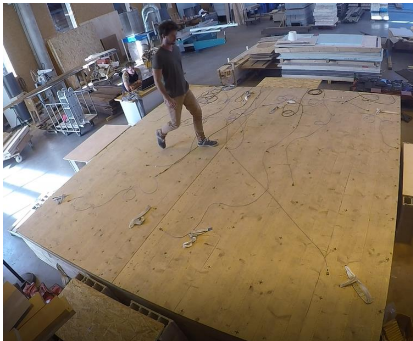
Figure 60 - Image tirée d'un essai de marche sur le plancher CLT
