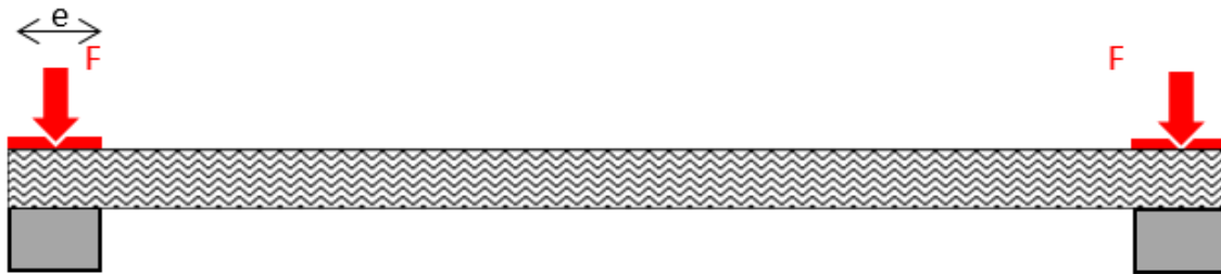
Figure 101 - Schéma du plancher sous l'effet d'un serrage aux extrémités
