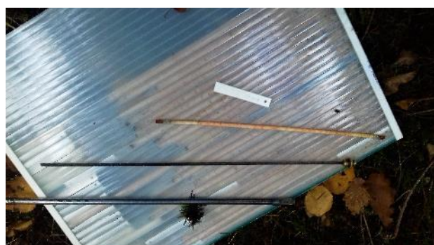
Figure 8 : carotte de bois, tarière de Pressler et extracteur
