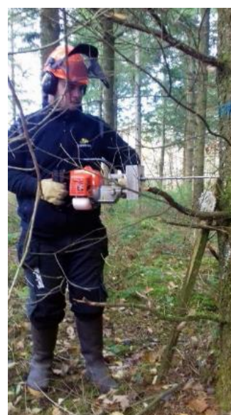
Figure 7 : prélèvement d'une carotte de bois à la tarière de Pressler
